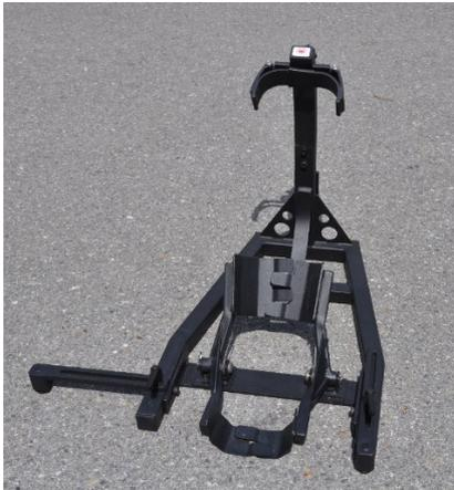
7. Bei geringen Unebenheiten können Sie die Stabilität weiter erhöhen, indem Sie den höhenverstellbaren Gelenkfuß ausdrehen bis Moto-Crab fest aufliegt.
