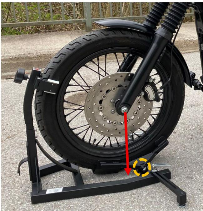
Der Achsmittelpunkt des Vorderreifens (rote Linie) muss sich nach dem Einschieben des Motorrades in den Ständer etwas vor der Kippachse (gelb) der unteren Krabbe befinden wie im Foto dargestellt.
