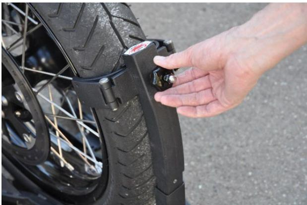
11. Gegen Diebstahl kann die obere Krabbe mit einem Sicherheitsverschluss (Sonderzubehör) verschlossen werden. Die Spannschraube lässt sich dann nicht mehr öffnen.
